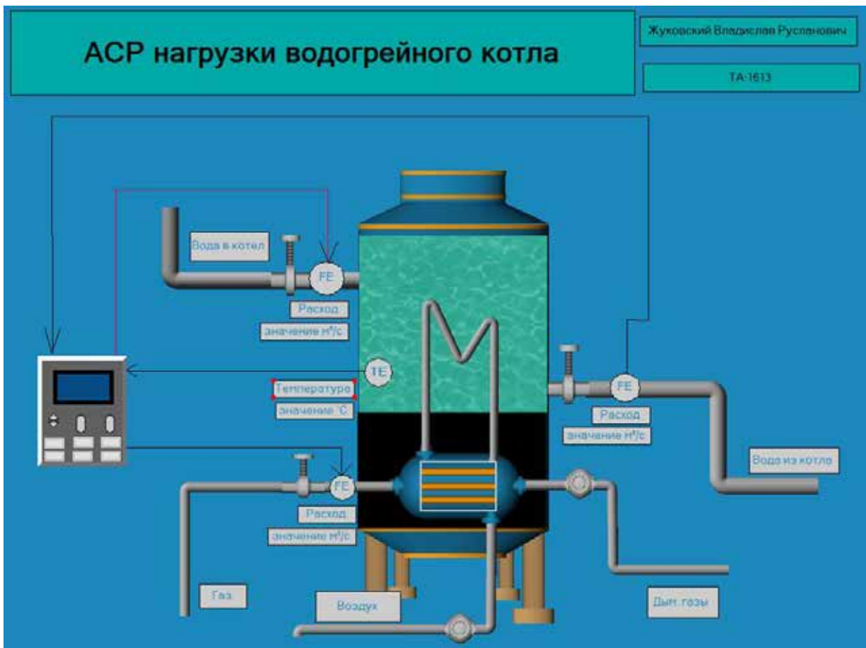
Рис. 6. Мнемосхема АСУ навантаження водогрійного котла
