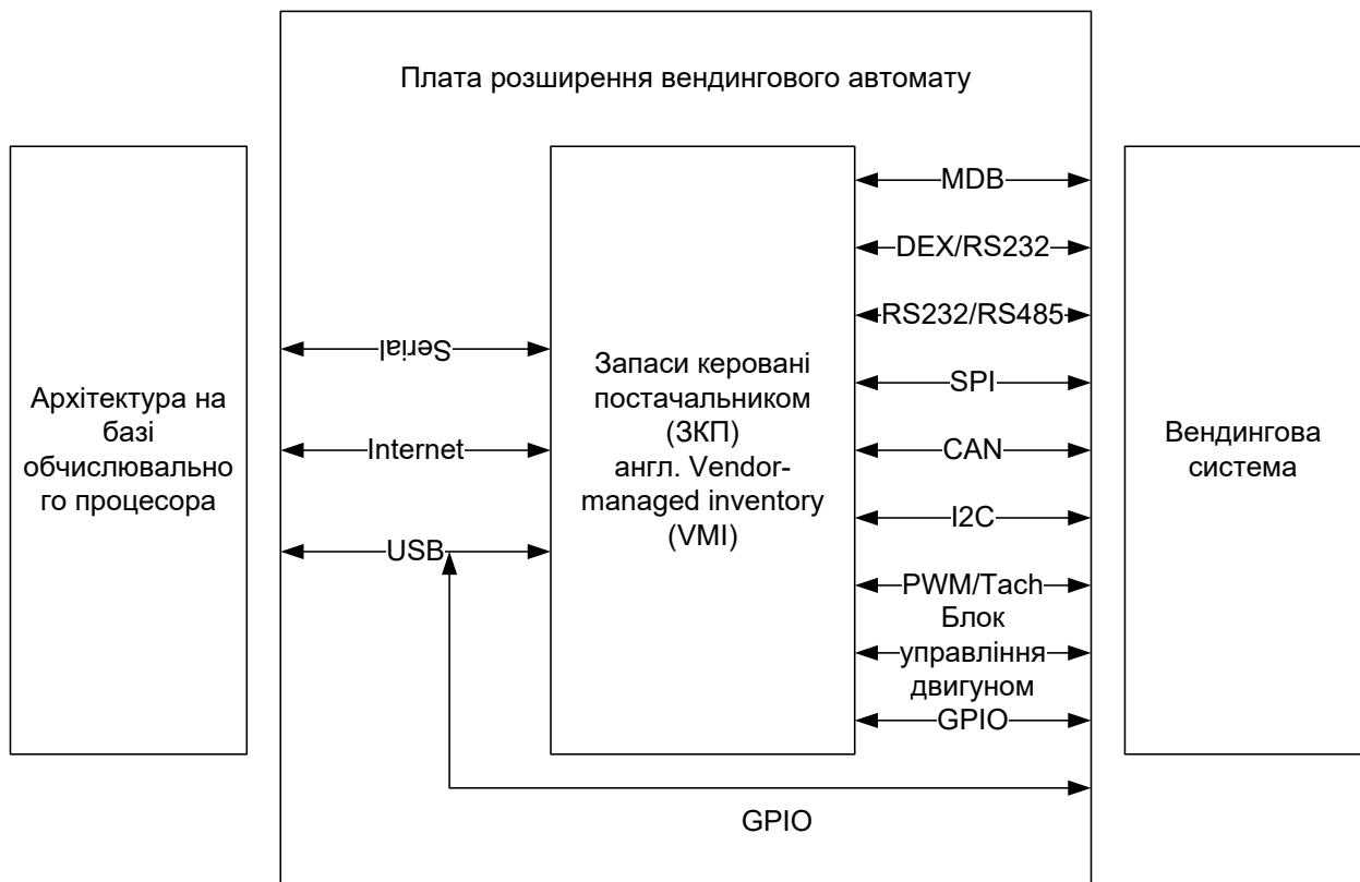
Рис. 2. Плата вводу-виводу вендингового автомату
